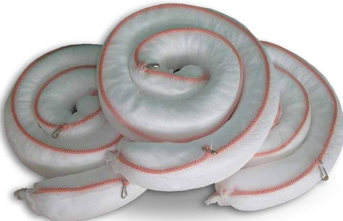
Questo prodotto è indispensabile in caso di versamenti di oli in superfici e corsi d'acqua. Le barriere hanno anelli e moschettoni in acciaio alle estremità per poterle ancorare o collegare facilmente in modo da arginare, contenere e assorbire il materiale. Sono inaffondabili anche quando completamente saturate e l'involucro in rete resiste ai raggi ultravioletti.
