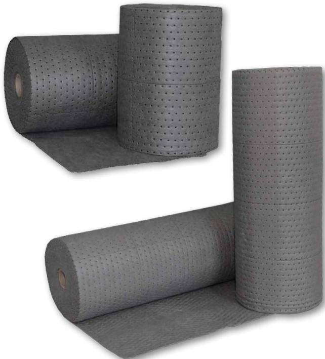
Composti da fogli con **saldatura ad ultrasuoni**, che unisce due strati esterni di polipropilene (fine fiber) ed uno interno di spesso tessuto assorbente (melt blown). L'innovativa tecnologia di **soffiaggio a caldo** permette la fusione e la filatura del polipropilene, e questa speciale composizione impedisce la perdita di fibre conferendo resistenza allo strappo e alla pressione anche a completo assorbimento. Questi rotoli sono adatti ad un trattamento rapido su superfici estese.
