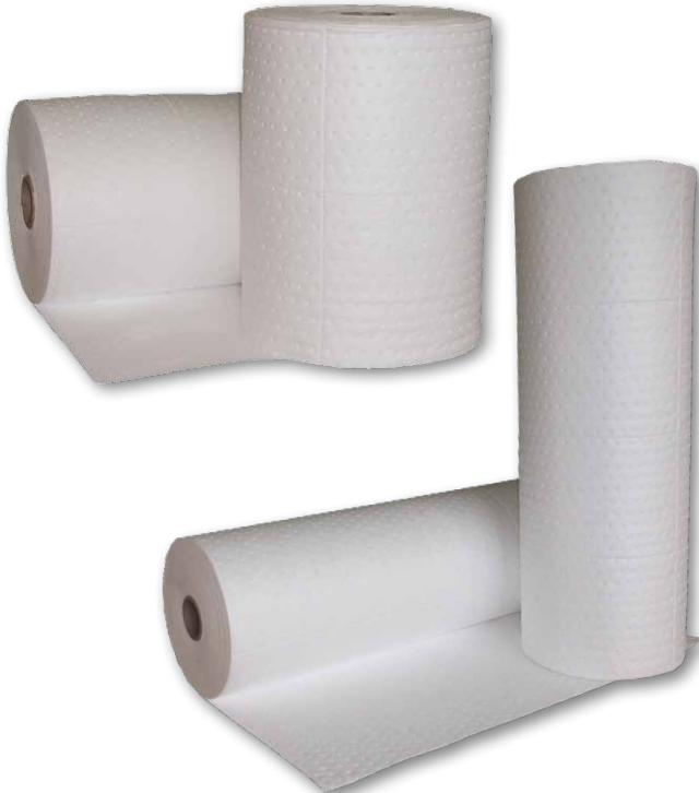
Rotoli pretagliati con punti leganti termici, costituiti da due strati esterni di propilene (fine fiber) e uno spesso strato interno (350 gr/mq) di tessuto assorbente (melt blown). Gli strati multipli saldati ad ultrasuoni impediscono la perdita di fibre e conferiscono resistenza all'abrasione, i punti leganti termici garantiscono maggiore compattezza una volta raggiunta la saturazione del foglio. Perforati longitudinalmente e trasversalmente. Grammatura 350.
