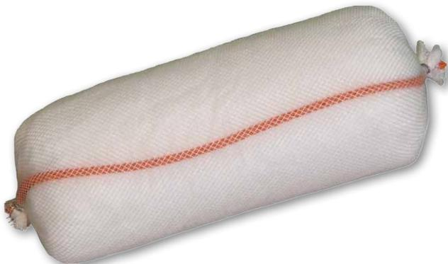
Le boe rimuovono in maniera facile e rapida idrocarburi e derivati dell'acqua all'interno di pozzetti, serbatoi o fosse. Sono inaffondabili anche quando completamente saturate, dotate di una corda per tutta la lunghezza che ne aumenta la robustezza.
